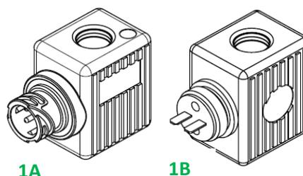
Elektromagnetický vzduchový ventil se skládá ze dvou hlavních částí: Elektromagnetu (1) a vzduchového systému (2 – 6). Elektromagnet tvoří plastový zástřík cívky opatřené konektorem bajonetem DIN 72585(1A) , nebo plochými kontakty(1B).
