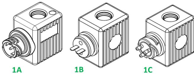
Elektromagnetický vzduchový ventil se skládá ze dvou hlavních částí: Elektromagnetu (1) a vzduchového systému (2 – 6). Elektromagnet tvoří plastový zástrček cívky opatřené konektorem bajonetem DIN 72585(1A) , nebo plochými kontakty(1B), nebo EURO konektorem (1C).
